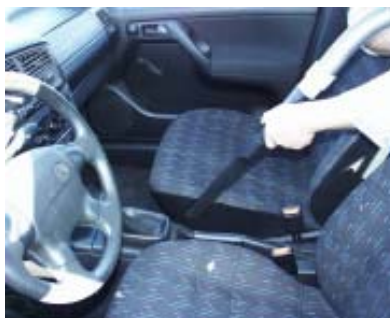
Om du ska suga i trånga eller djupa veck, t ex mellan bilsäten eller vid rengöring av maskiner, använd det 300 mm långa elementmunstycket, best.-nr.: 58 402 3
