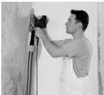
För att suga upp damm som uppstår vid elverktyg, styrs av inkopplingsautomatiken. Automatisk start samtidigt som du kopplas in elverktuget. (Best.-nr. 58 405 1)
