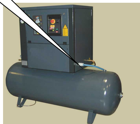
Elektrisk Ljuddämpande skruvkompressor monterad på tank.
