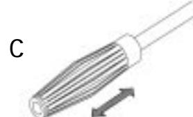
Zur Erreichung des Niederdrucks Varioregeldüse verschieben !
