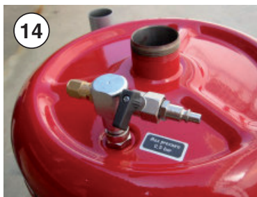
Montera den medlevererade kopplingen på tryckventilen eller en snabbkoppling. Stryk tätningsmedel på gängan.
