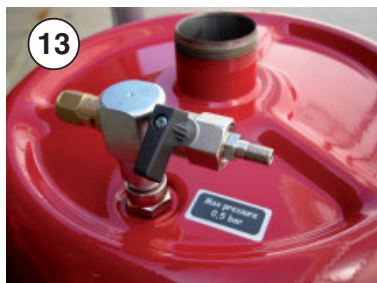
Montera den medlevererade kopplingen på tryckventilen eller en snabbkoppling. Stryk tätningsmedel på gängan.
